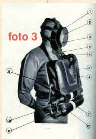
Le parti componenti un apparato ad ossigeno:
